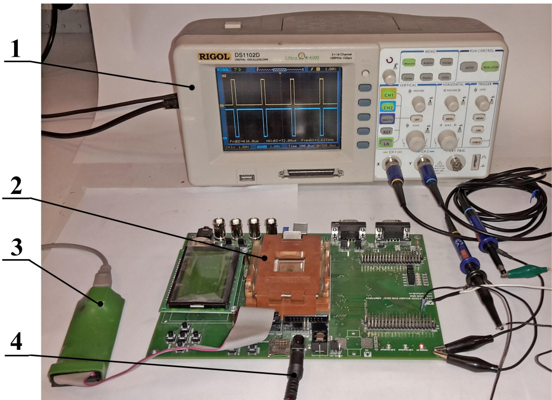
Рисунок 11.1 Общий вид лабораторной установки: 1 – осциллограф; 2 – отладочная плата; 3 - программатор J-Link ARM; 4 – шнур питания.
