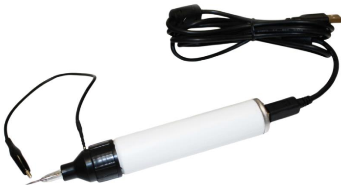
Рисунок 4.2 – Универсальный осциллограф-приставка к ПК
