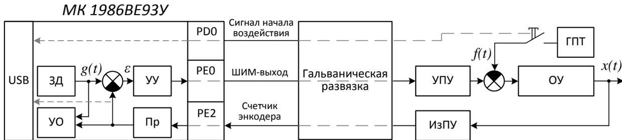
Рис. 7.2. Функциональная схема цифровой системы автоматической стабилизации скорости вращения:
