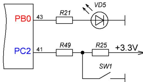
У нас есть два вывода МК, к одному из них (PB0 – нулевой бит **32ух разрядного регистра «В»**, отвечающего за **16ти разрядный порт «В»**) подключен светодиод. Сам он ничего не даёт контроллеру, а лишь отображает уровень напряжения на его выводе. Значит, наш светодиод принимает данные, а микроконтроллер их передаёт.
