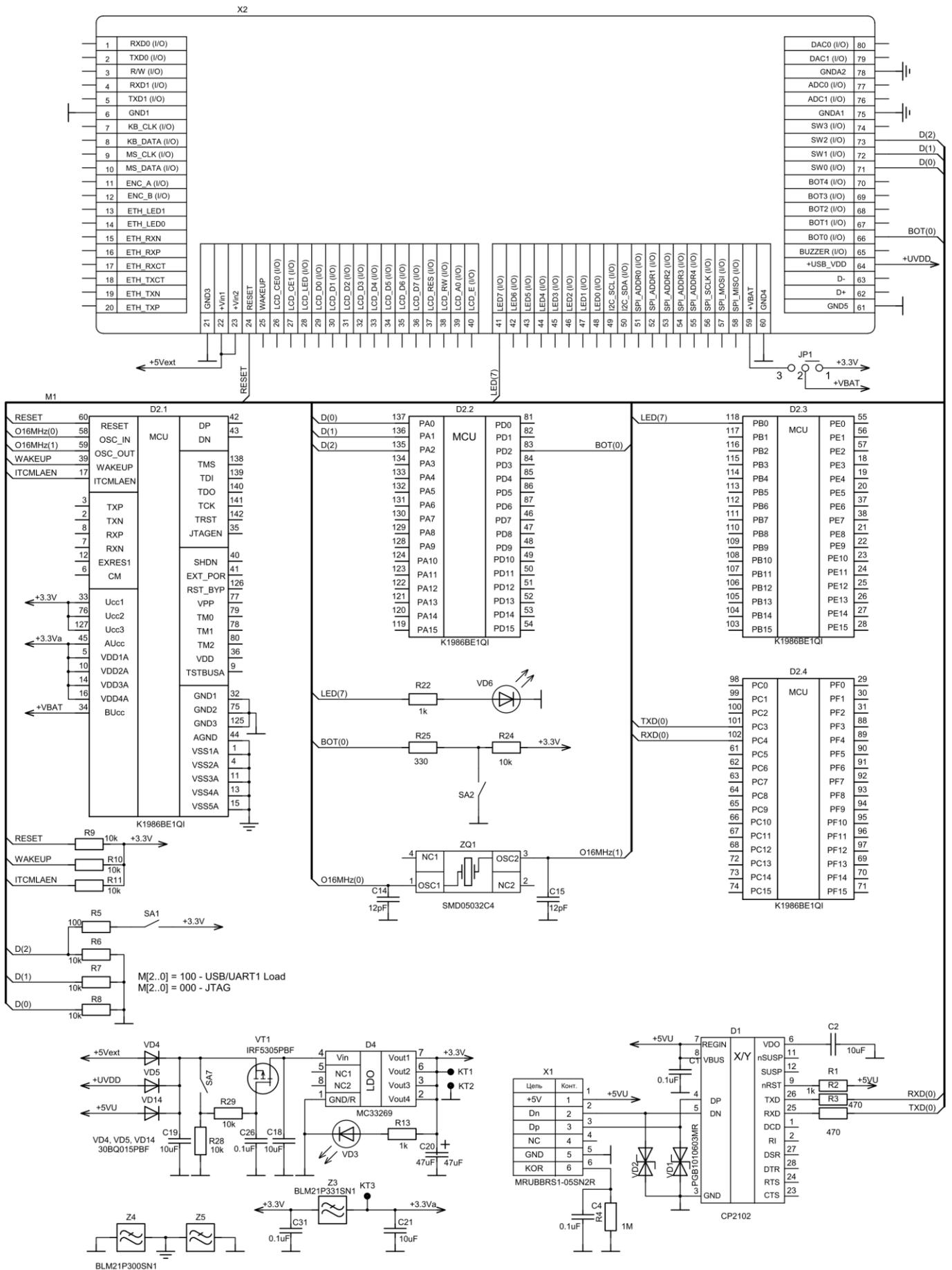
Рисунок 2. Эквивалентная электрическая принципиальная схема платы LDM-HELPER-K1986BE1QI для примера 3.
