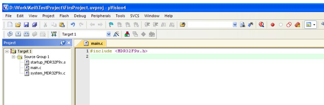
Далее, добавим в наш файл **main.c** собственно код самой функции main, который пока ничего не будет делать, но внутри которого потом будет размещён основной алгоритм работы программы.
