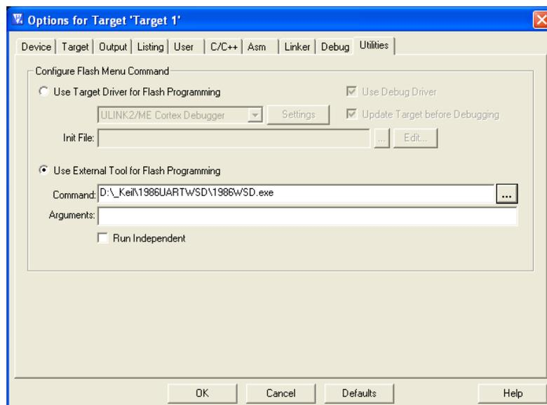
Теперь саму программу можно вызывать из главного окна среды разработки, нажатием на кнопку «Load»
