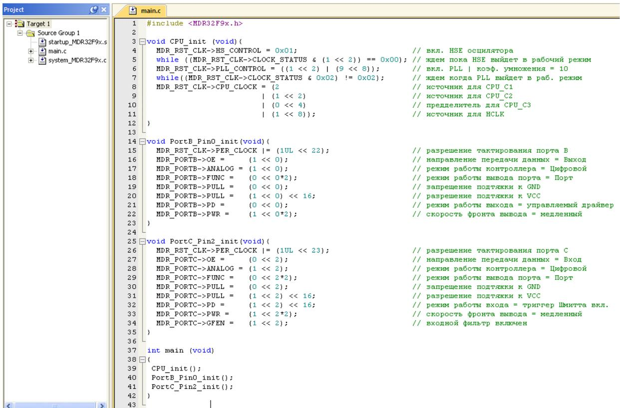
Теперь добавляем основной цикл работы программы, в результате получив такую вот законченную и рабочую конструкцию.
